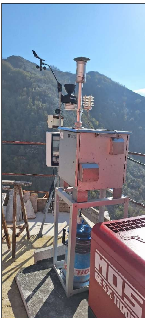
Figura 4: postazione di misura PM10 con Sky-post presso area servizi Cava Ortensia
