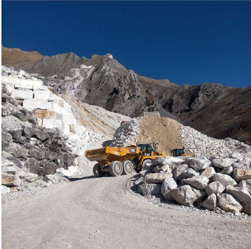
**Figura 22:** Operazioni di dumperaggio con allontanamento dei materiali derivati dai cantieri.
