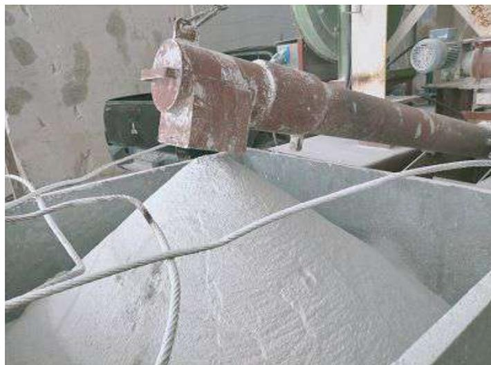
**Figura 23:** Raccolta delle polveri provenienti dalla tagliatrice a catena in galleria
