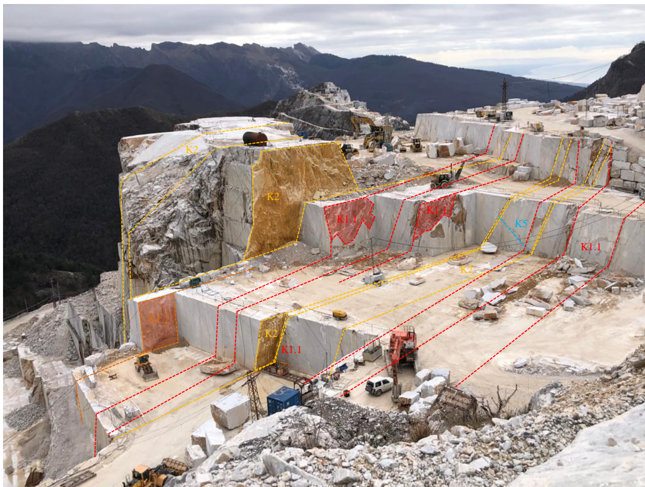
Figura 14 - vista della porzione a confine con la cava n.150 "Fossaficola A" con riportate la traccia delle strutture principali (rosso: K1.1, arancione K1.2, giallo: K2, azzurro: K5)
