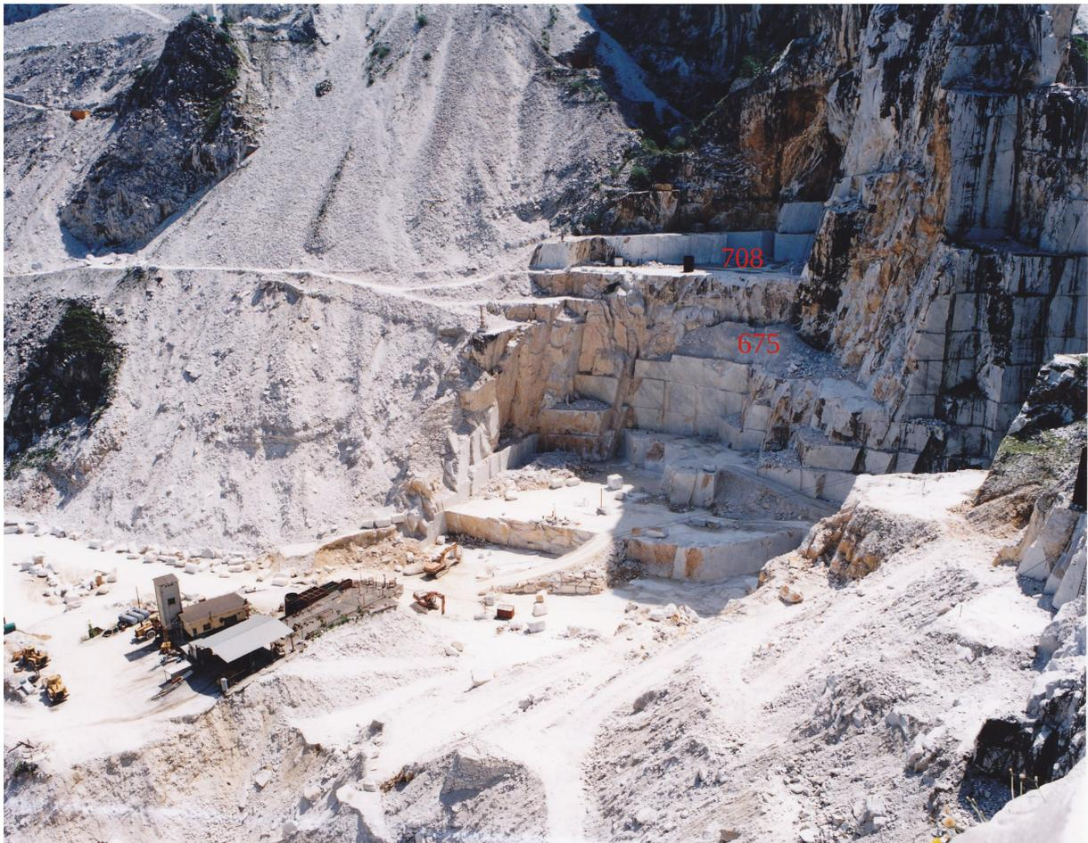
Foto – Vecchia foto della cava Torrione. Si possono osservare le vecchie bancate sepolte che si intende scoprire ed in particolare i piazzali alle quote 675 m e 708 m ca.
