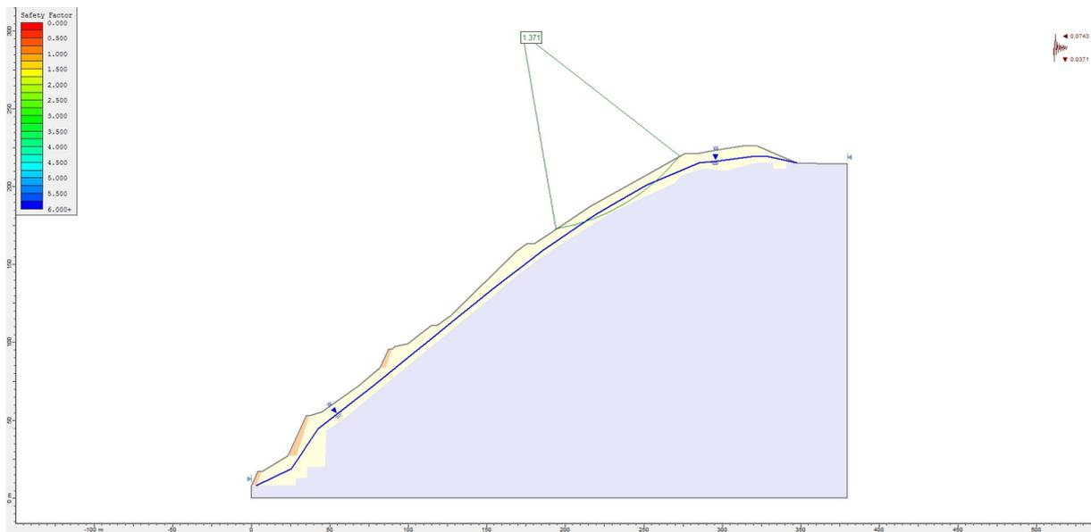
Analisi delle possibili linee di scivolamento per la sezione progettuale in condizioni pseudostatiche.
