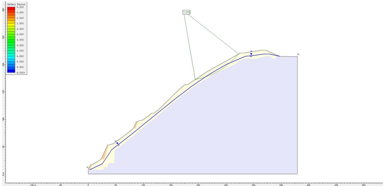
Analisi delle possibili linee di scivolamento per la sezione progettuale in condizioni statiche.
