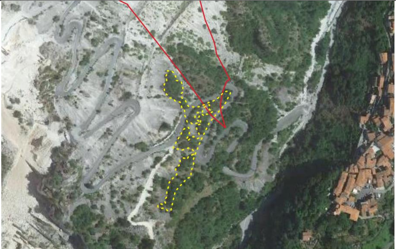
Sviluppo planimetrico su ortofoto dell'area oggetto di valutazione dello stato di rinaturalizzazione. In giallo il perimetro dell'area di cava, in giallo il perimetro del ravaneto R1 da tutelare, di cui solamente la parte interna al perimetro di cava (in rosso) è oggetto di valutazione.
