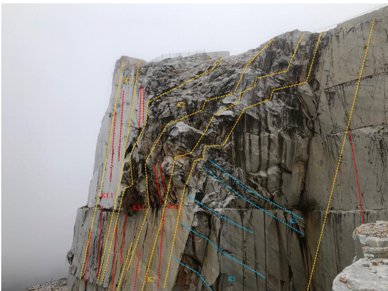
Figura 14 – vista dello "zucchetto sud", con riportate le strutture principali (rosso: k1.1, giallo: K2, verde: K3, azzurro K5)
