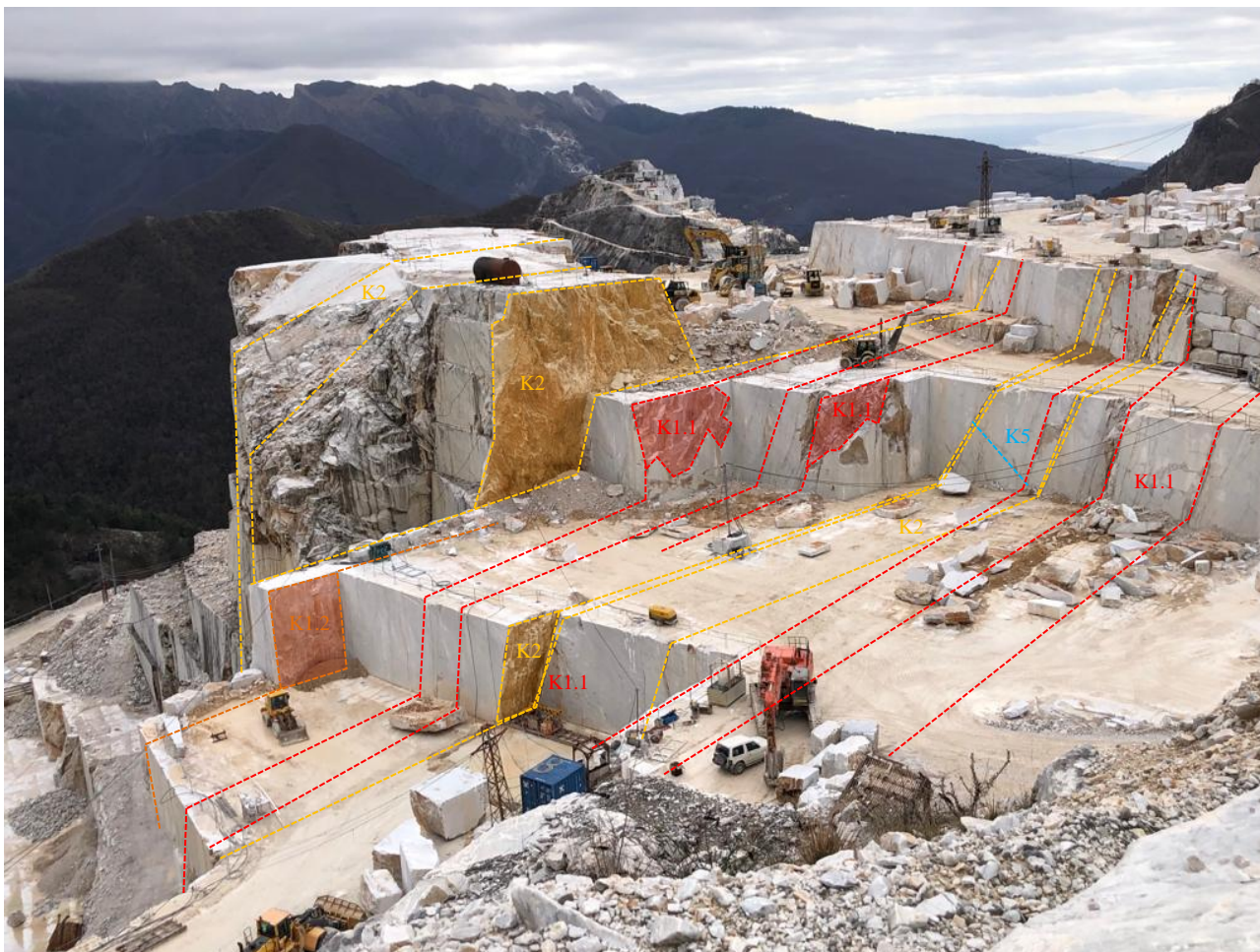
Figura 15 - vista della porzione a confine con la cava n.150 "Fossaficola A" con riportate la traccia delle strutture principali (rosso: K1.1, arancione K1.2, giallo: K2, azzurro: K5)
