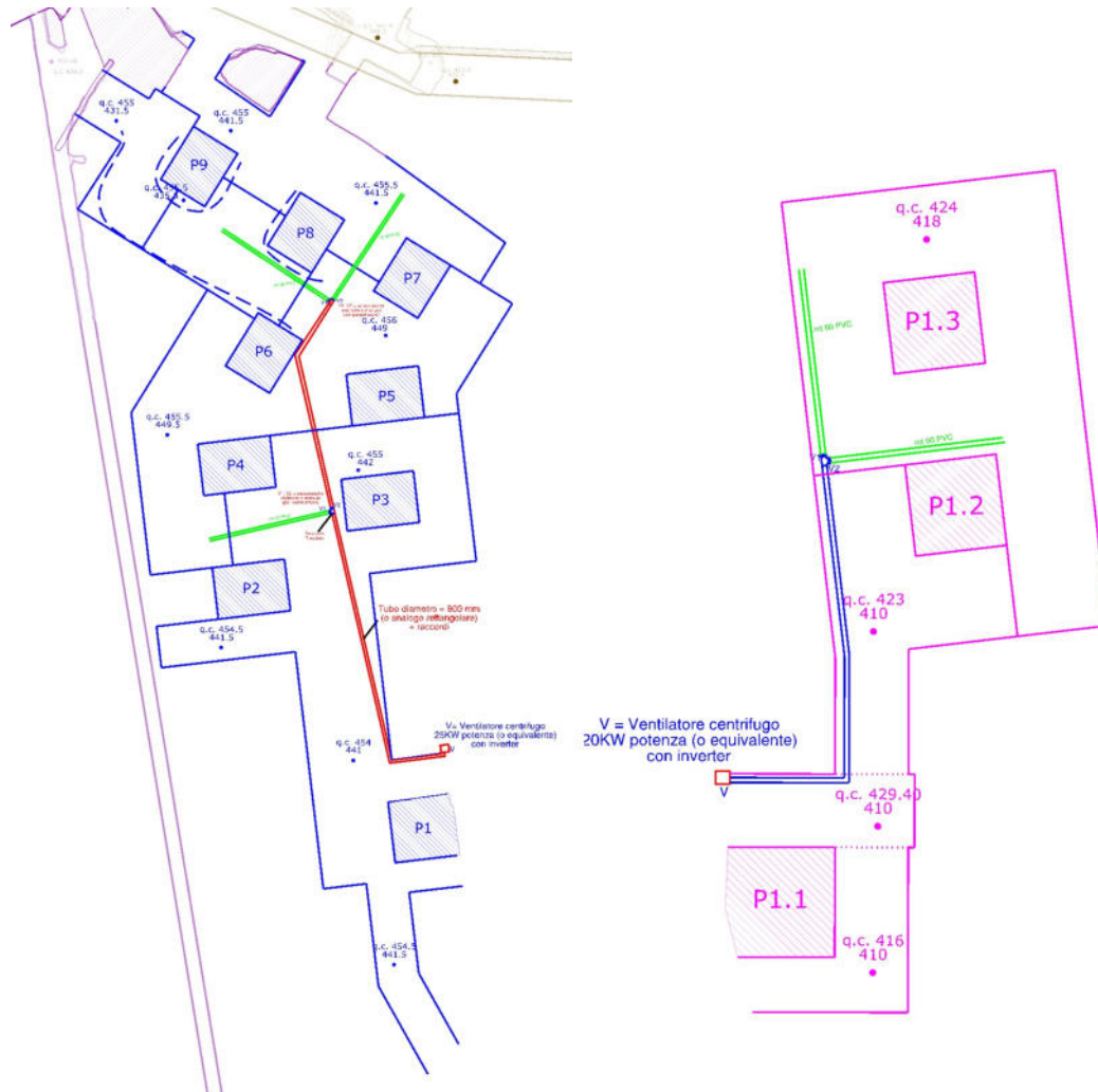
Schema impianti di ventilazione
