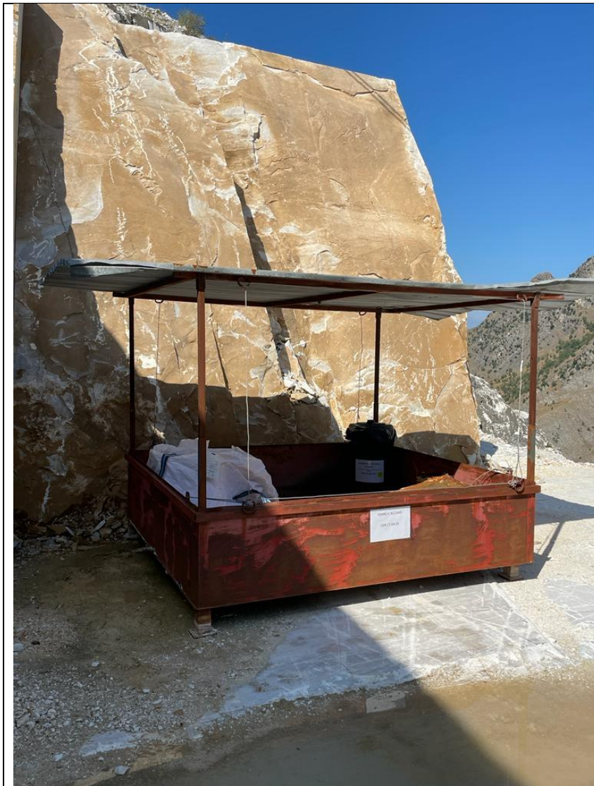
Foto 4: contenitore in ferro con tettoia all'interno del quale sono posti residui ferrosi, plastici e/o materiali assorbenti e filtranti prodotti giornalmente e ivi depositati fino a termine turno, per essere poi trasferiti nei relativi depositi posti nelle adiacenze della strada comunale.
