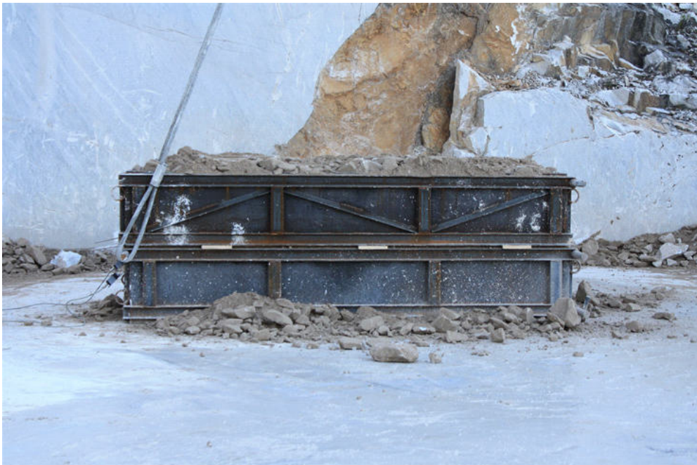
Apparecchiatura utilizzata per le prove di taglio e di tilt test
