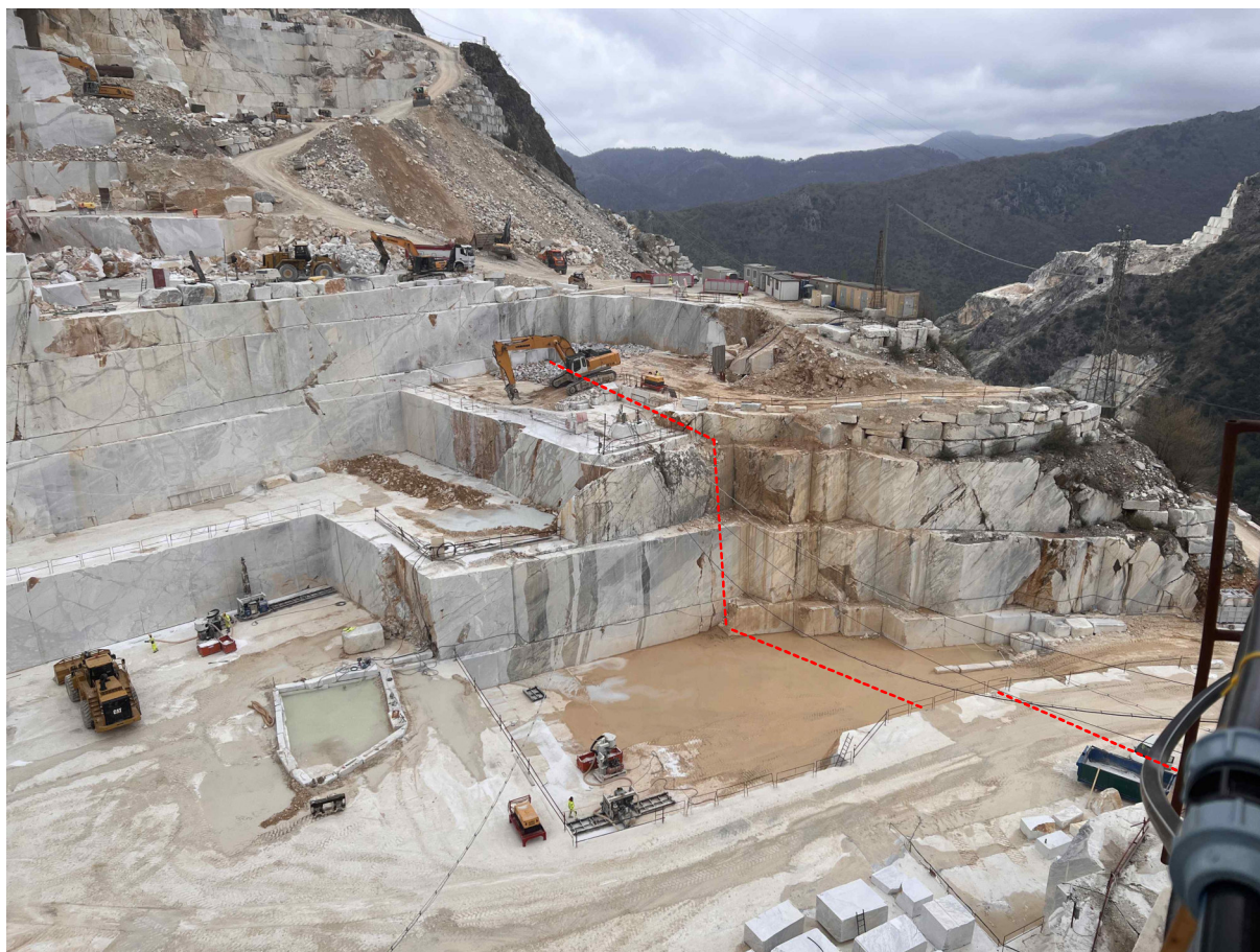
Panoramica verso SW con visibile la fascia di materiale non produttivo.
