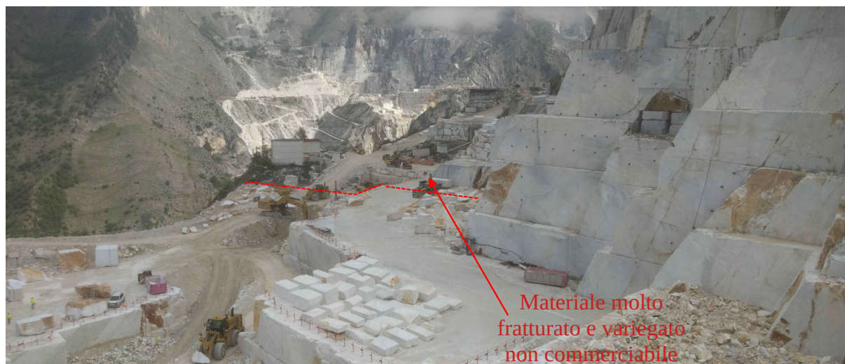
Panoramica vecchia principale immergente mediamente a N-O con visibile la fascia di materiale non produttivo a dx della linea rossa.
