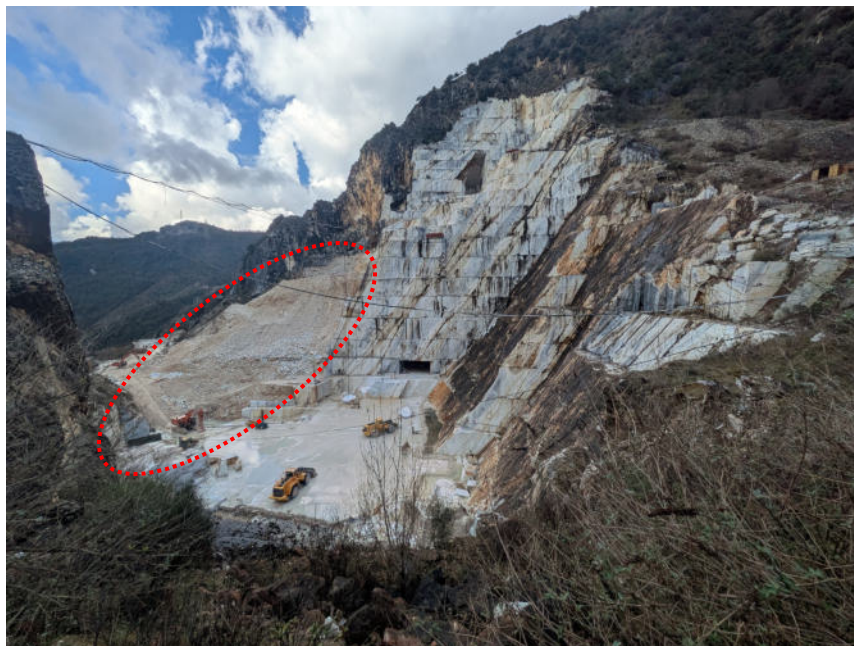
Vista del cumulo detritico risultante dalle attività di bonifica del cantiere “superiore”, da rimuovere per motivi di sicurezza che del buon governo del giacimento.
