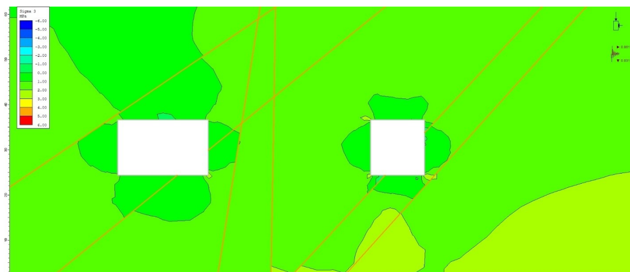
Figura 36 – Sezione D: componente principale minima del tensore degli sforzi ( \sigma_3 ), stato finale
