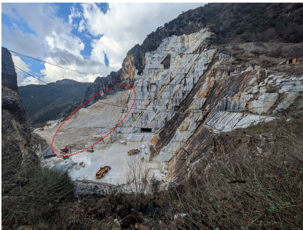
Figura 3 – Vista del cumulo detritico risultante dalle attività di bonifica del cantiere "superiore", da rimuovere per motivi di sicurezza che del buon governo del giacimento.
