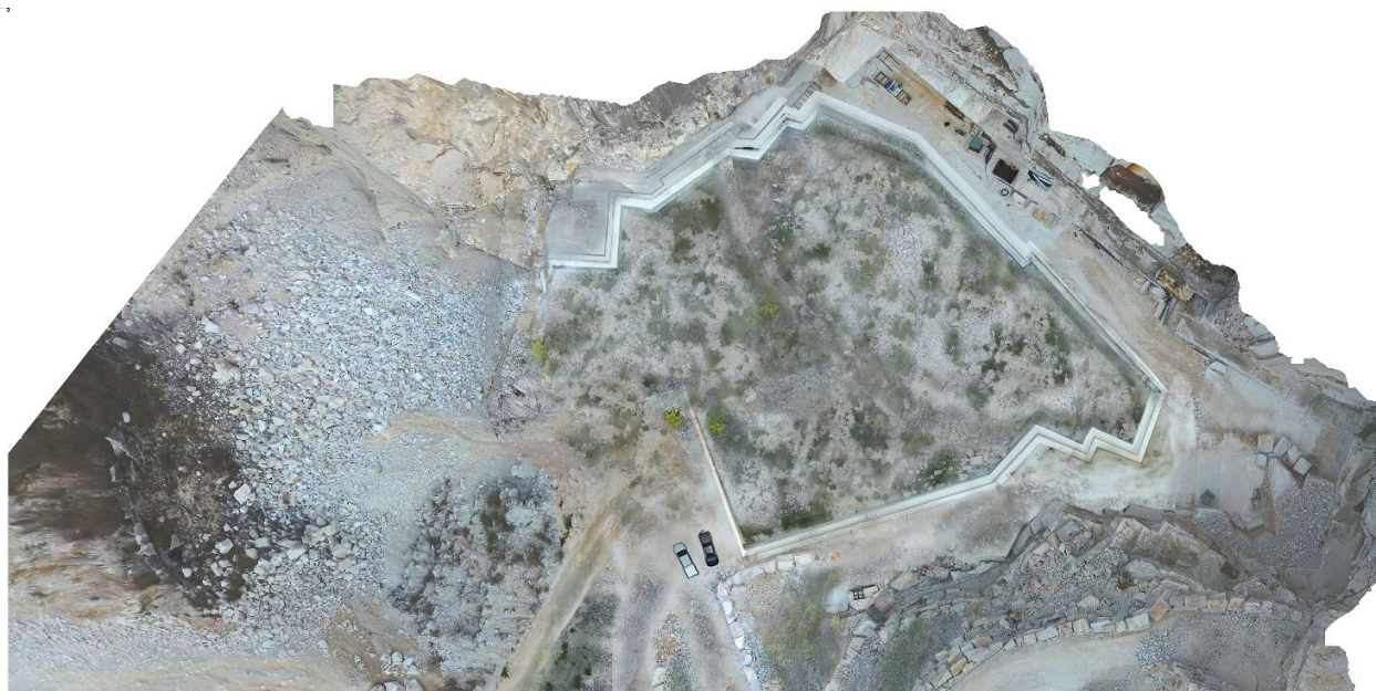
Figura 6- Ingrandimento del progetto di ricomposizione e mitigazione in una fase simulata a due anni dall'intervento. E' previsto un riempimento di materiale misto di diversa granulometria, vedi Figura 5, in grado di esercitare un valido drenaggio.
