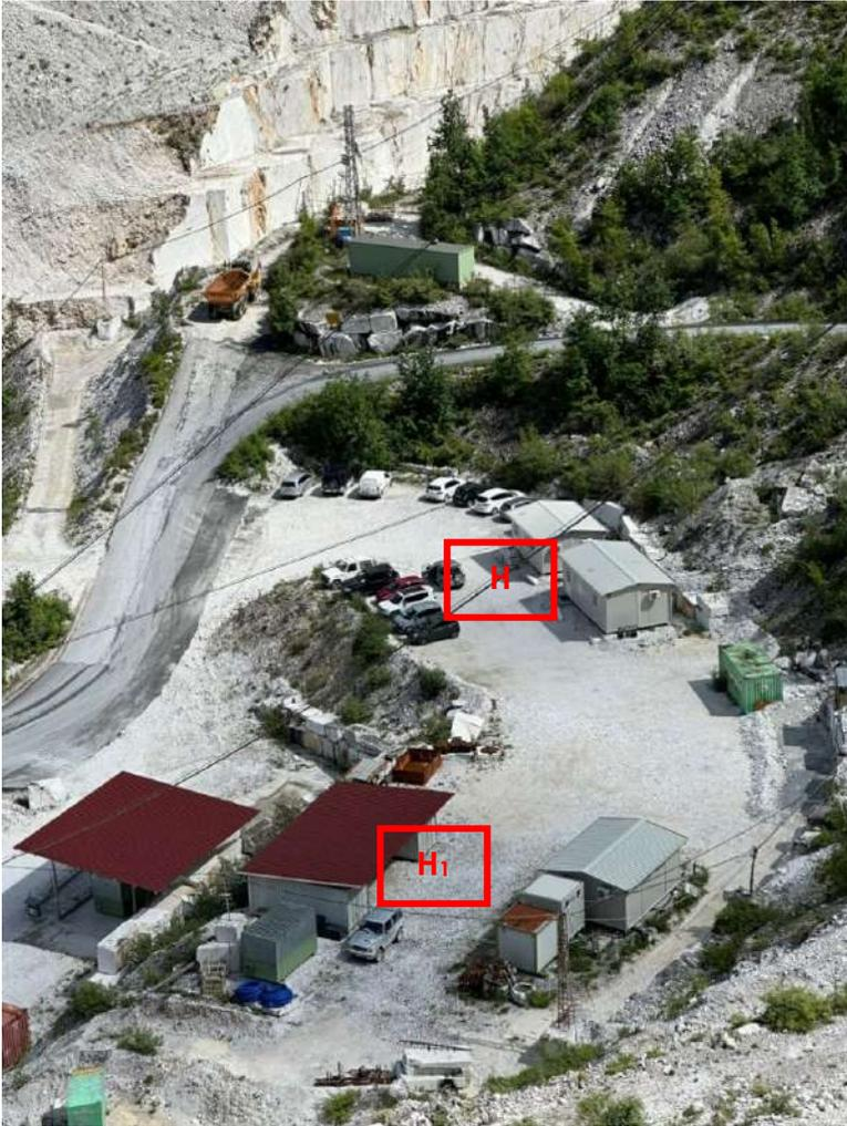
**Figura 18:** Panoramica delle aree impianti e servizi, con suddivisione di quest'ultima in H e H<sub>1</sub>, ambedue ricoperte con pietrisco 40/70mm.
