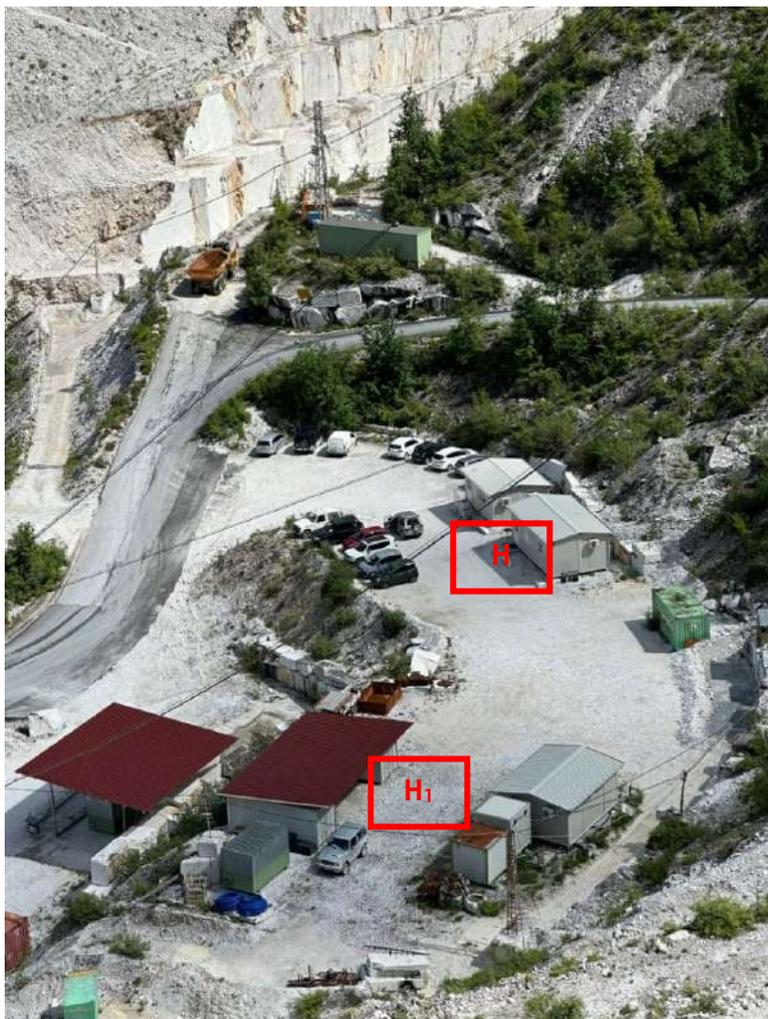
**Figura 5:** Panoramica delle aree impianti e servizi, con suddivisione di quest'ultima in H e H<sub>1</sub>, ambedue ricoperte con pietrisco 40/70mm.
