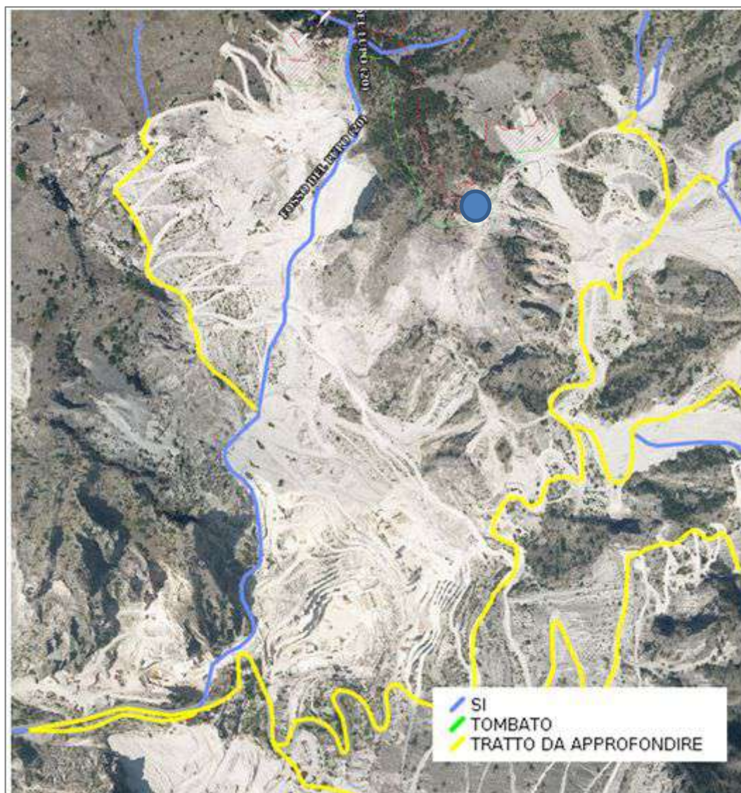
Figura 27: estratto della cartografia del Reticolo idrografico regionale, aggiornato DCRT N.55/23 con in azzurro il reticolo idrografico e in giallo i “tratti da approfondire”, in blu indicativamente, la localizzazione della Cava n.26.
