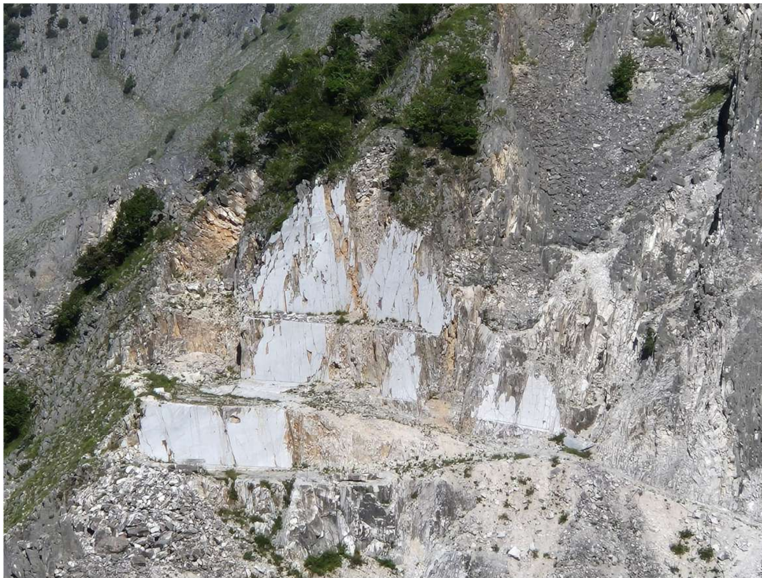
Figura 3: Dettaglio dei gradoni attuali, area che sarà oggetto degli interventi di recupero ambientale.
