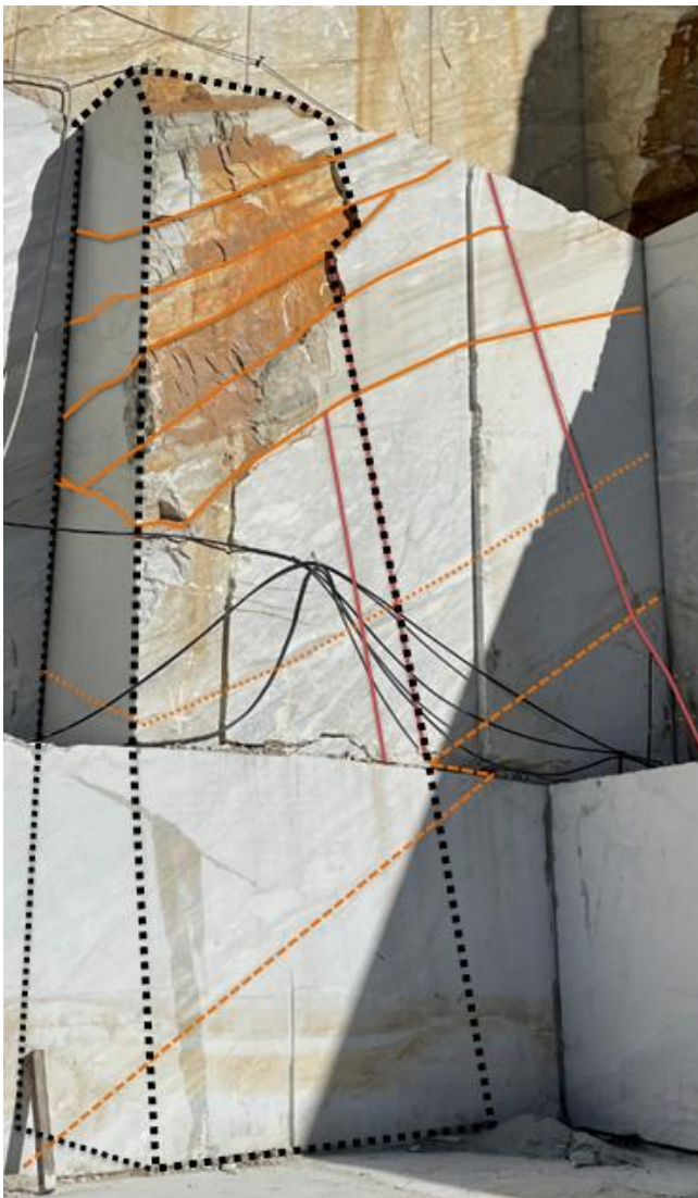
Figura 14: Fotorestituzione della spalla destra con indicate le principali discontinuità rintracciate e l'elemento da consolidare.
