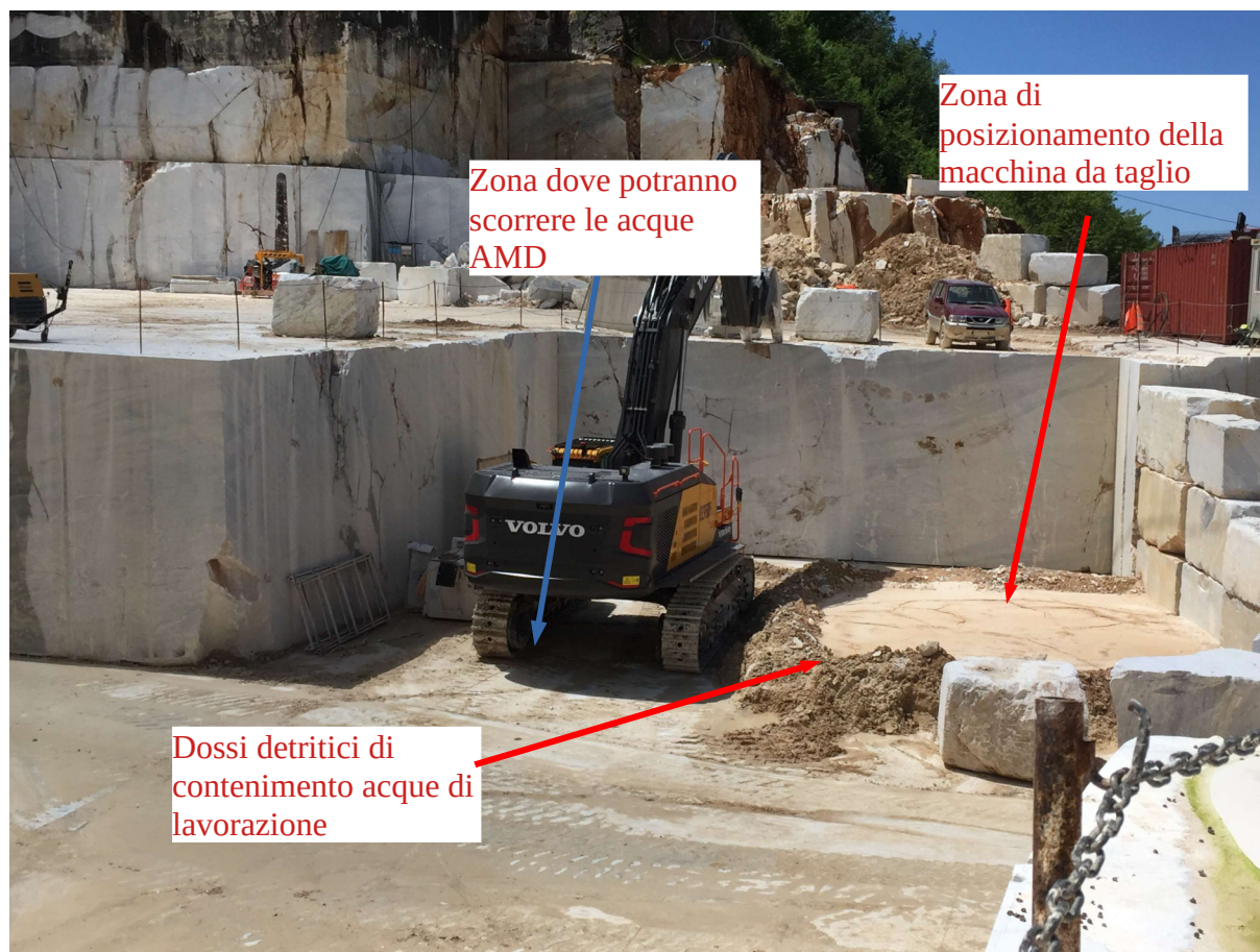
Esempio di contenimento acque di lavorazione nel cantiere a cielo aperto
