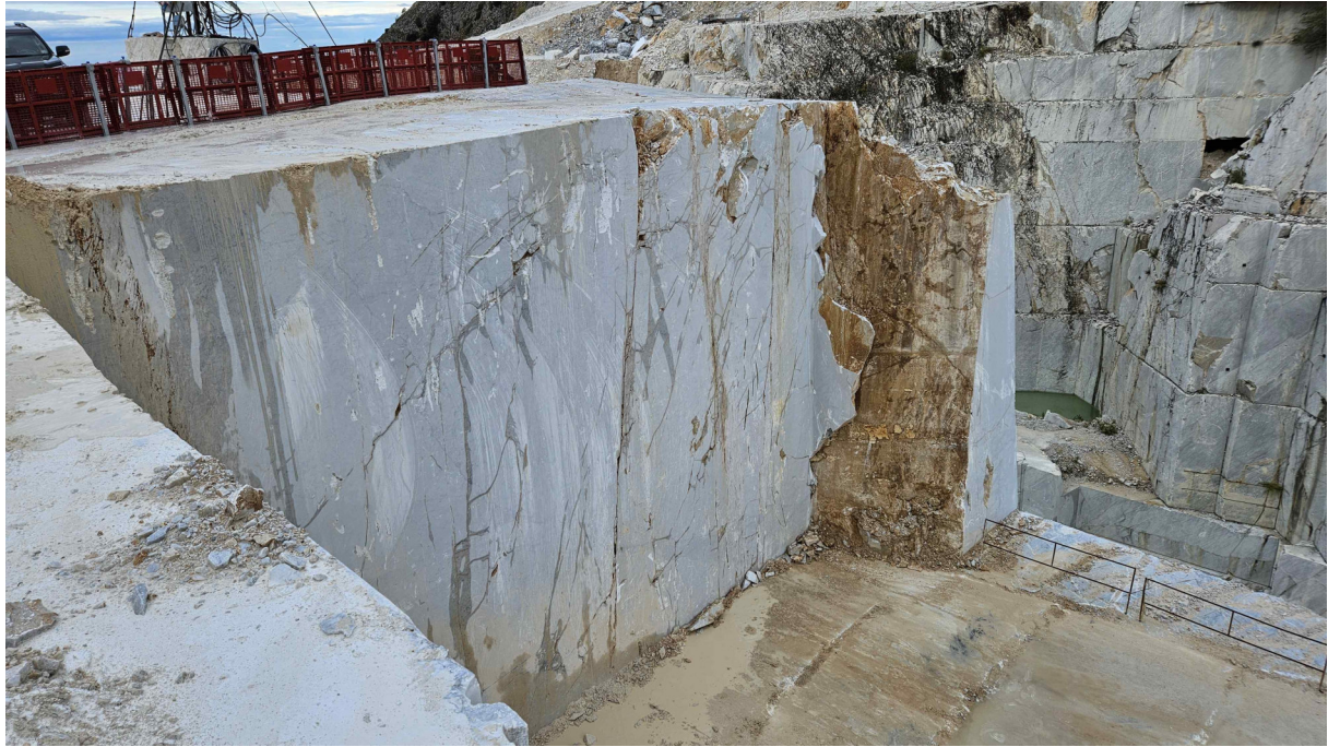
Foto 5 – Dettaglio della parete S che illustra la fascia fratturata sul confine con la cava 153 (cantiere che si intravede al piano inferiore)
