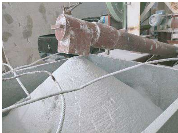
Figura 18: Raccolta delle polveri provenienti dalla tagliatrice a catena in galleria
