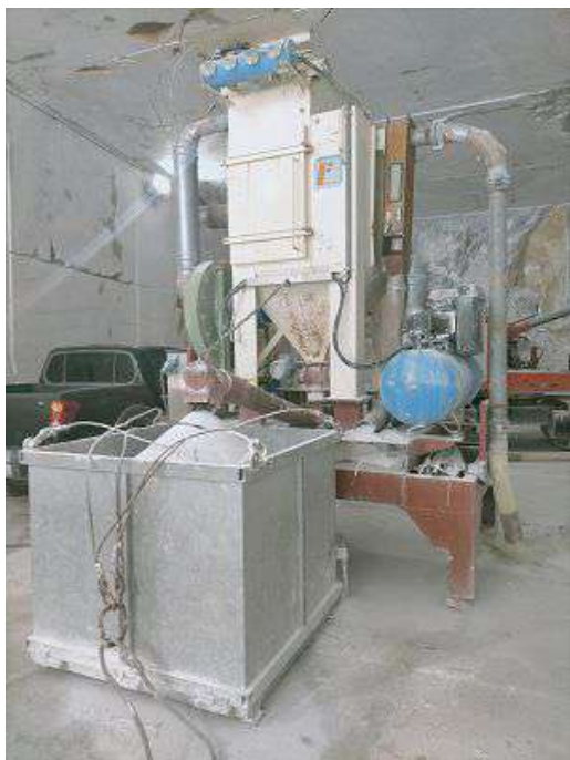
Figura 18: Raccolta delle polveri provenienti dalla tagliatrice a catena in galleria
