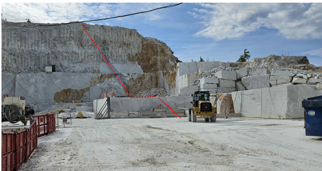
Panoramica tecchia principale immergente mediamente a N-O con visibile la fascia di materiale non produttivo.
