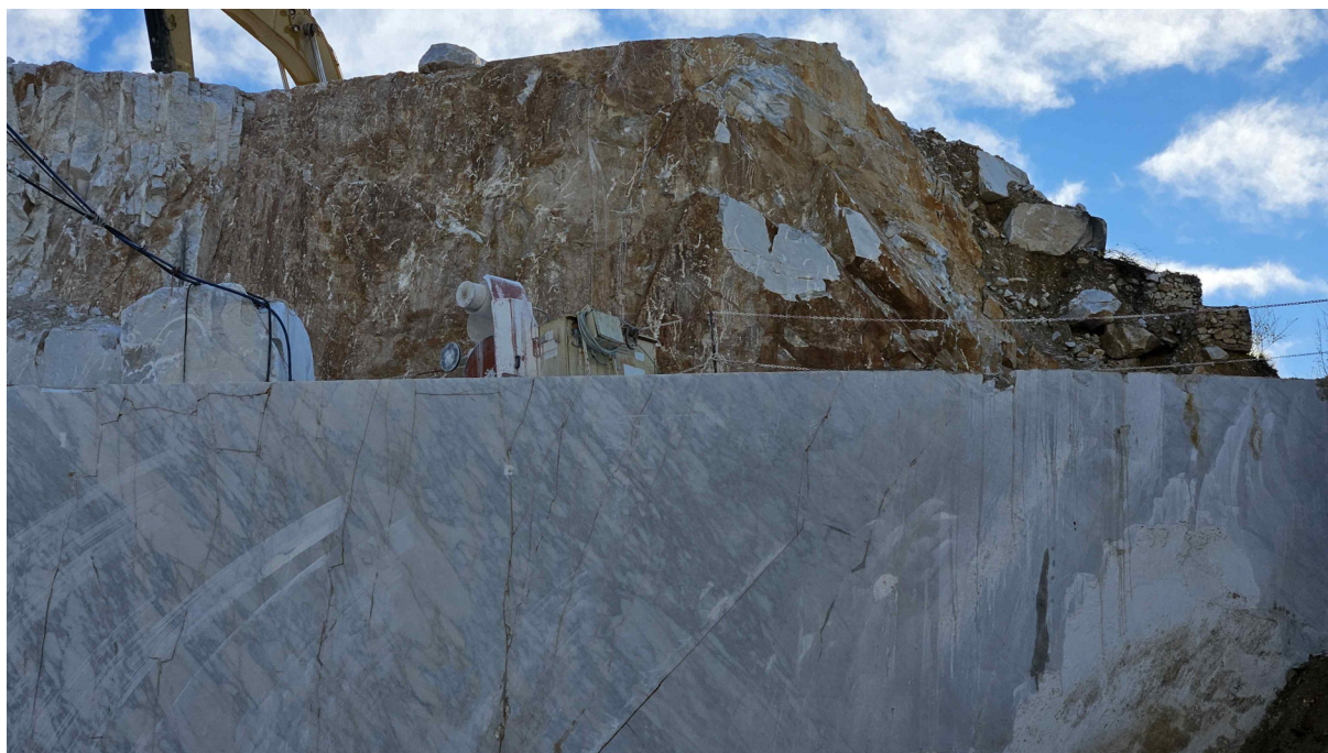
Esempi di fratture che interessano la porzione materiale improduttivo
