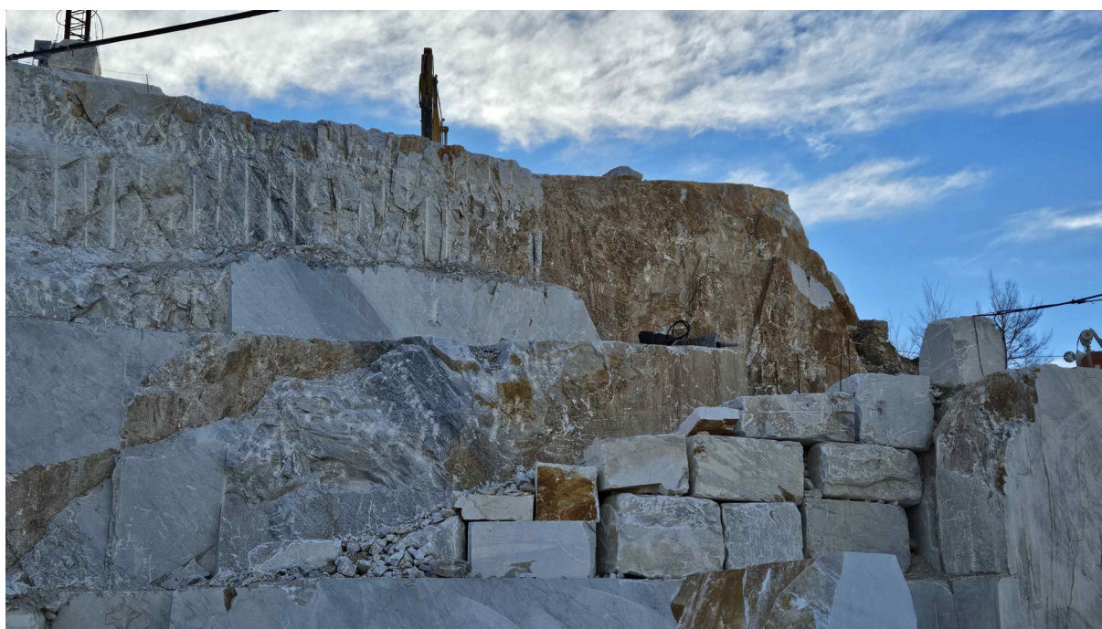
Esempi di fratture che interessano la porzione materiale improduttivo
